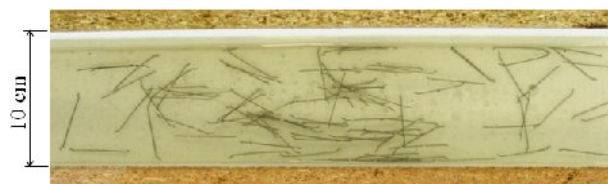
Figure 3. Ecoulement canal d'une solution de Carbopol fibrée ( \tau_0 = 27 Pa)
