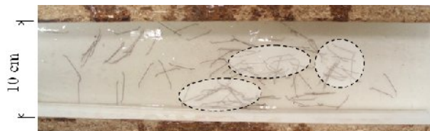
Figure 4. Ecoulement canal d'une solution de Carbopol fibrée ( \tau_0 = 70 Pa)
