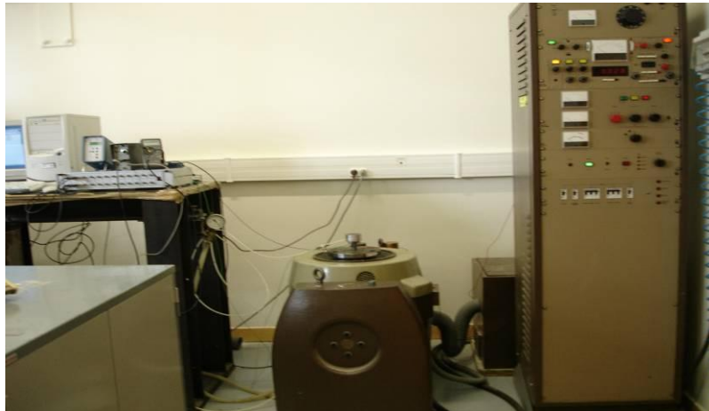
Figure 7. Le pot vibrant relié à l'armoire de commande
