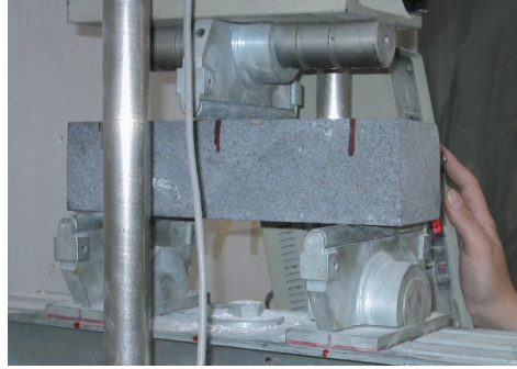
صورة 3. تبين توضع عينة الحجر في جهاز الانعطاف
