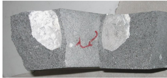
صورة 4. تبين العيب الموجود في العينة المكسورة على الانعطاف
